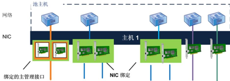
此图显示的主机配置了一个位于绑定上的管理接口，而且还绑定了两对 NIC 用于来宾系统通信。除了管理接口绑定，XenServer 还将另外两个绑定的 NIC 和两个非绑定的 NIC 用于 VM 通信。
