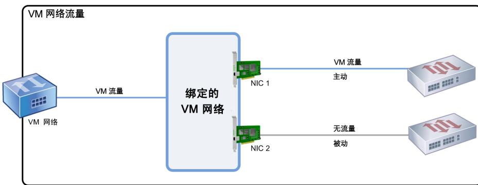
此图显示了在主动-被动模式下绑定的两个 NIC。NIC 1 处于活动状态。此绑定包含一个连接到第二台交换机用于故障转移的 NIC。此 NIC 仅在 NIC 1 发生故障时使用。
