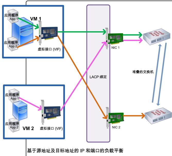
下图显示，如果您使用 LACP 绑定并启用将基于源和目标的 IP 与端口的负载平衡作为散列类型的 LACP，则来自 VM1 上两个不同应用程序的通信可分布到两个 NIC 上。
