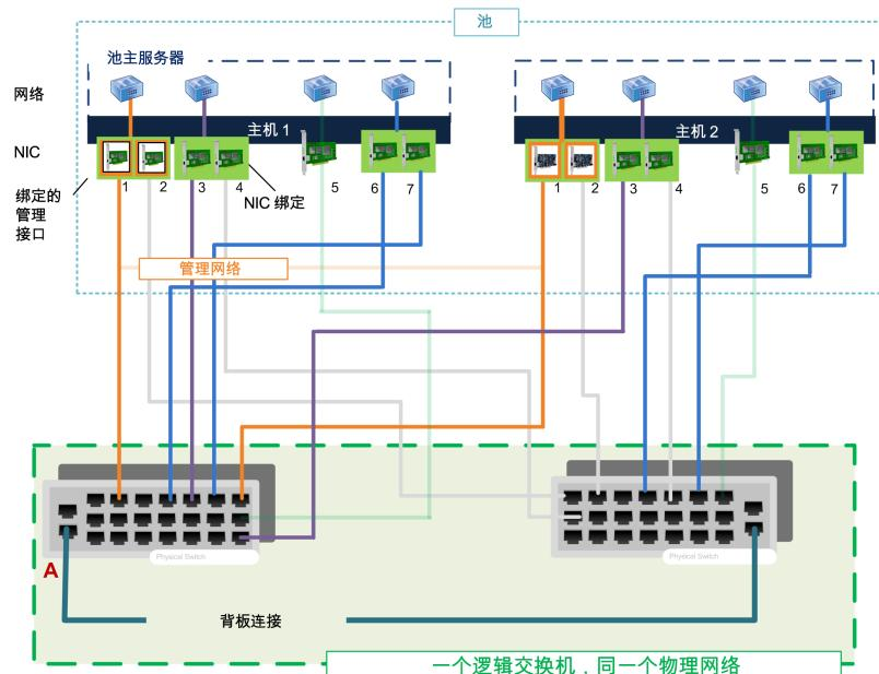
该图说明一个绑定对中的两个 NIC 如何使用相同的网络设置（由每个主机中的网络表示）。绑定的两个 NIC 连接到不同的交换机以实现冗余。
