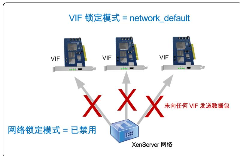
此图显示，当 VIF 配置为默认设置 (locking-mode=network\_default) 时，如何查看与 default-locking-mode 相关联的设置。在此图中，网络被设为 default-locking-mode=disabled，使任何通信都无法经过 VIF。
