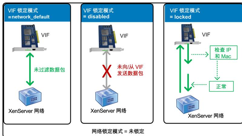
此图显示将网络锁定模式设为已解除锁定和配置 VIF 状态时，三种不同的 VIF 锁定模式状态的行为方式。在第一张图中，VIF 状态被设为默认设置，因此，不过滤来自 VM 的通信。在第二张图中，VIF 不发送或接收任何数据包，因为此锁定模式被设为禁用。在第三张图中，VIF 状态被设为锁定，因此，如果这些数据包包含正确的 MAC 和 IP 地址，VIF 只能发送数据包。
