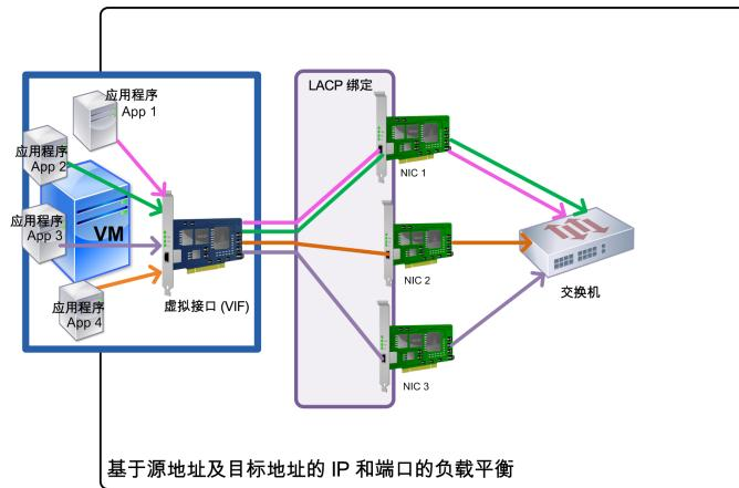
此图显示，如果使用 LACP 绑定并启用将基于源和目标 IP 与端口的负载平衡作为散列类型的 LACP，XenServer 能够通过绑定中三个 NIC 中的某个 NIC 传输虚拟机中每个应用程序的通信，即便 NIC 数量超出 VIF 数量。
